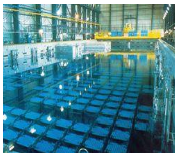
Kiegészített üzemanyag átmeneti tárolómedencéje egy franciaországi reprocesszáló üzemben.
