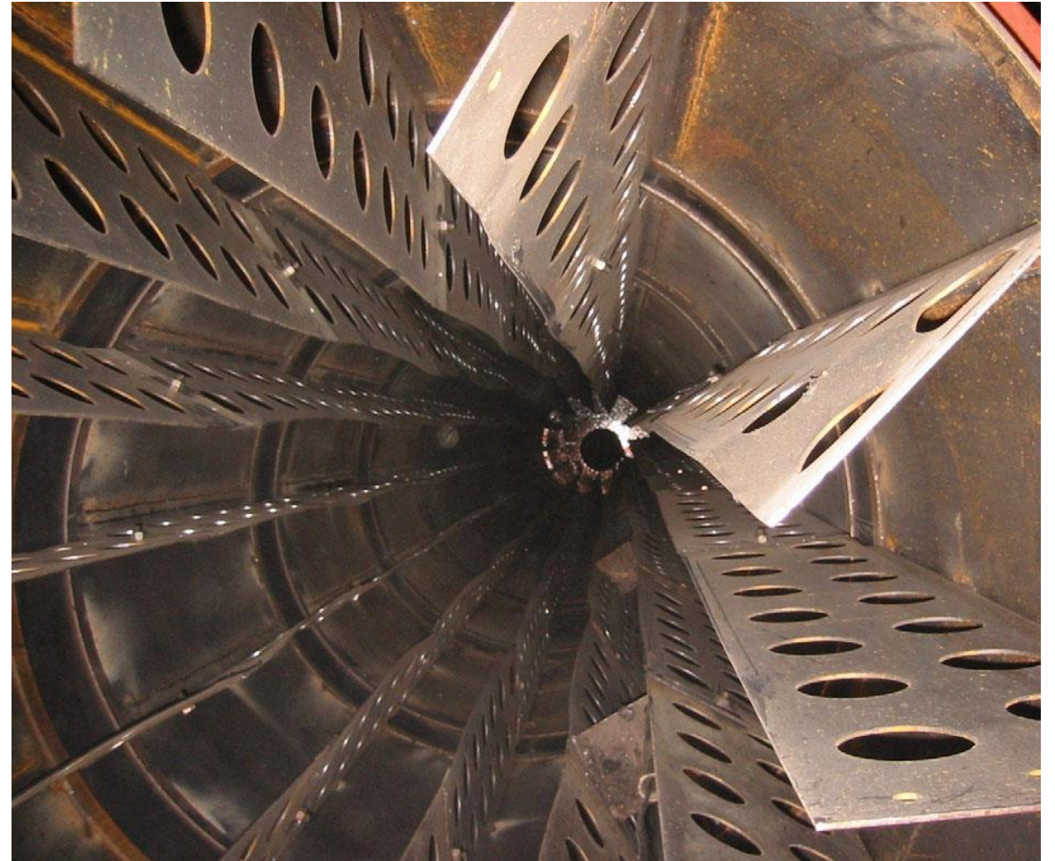
Söderberg-elektroda acélköpenye az elektródmassza visszatartó bordázattal
